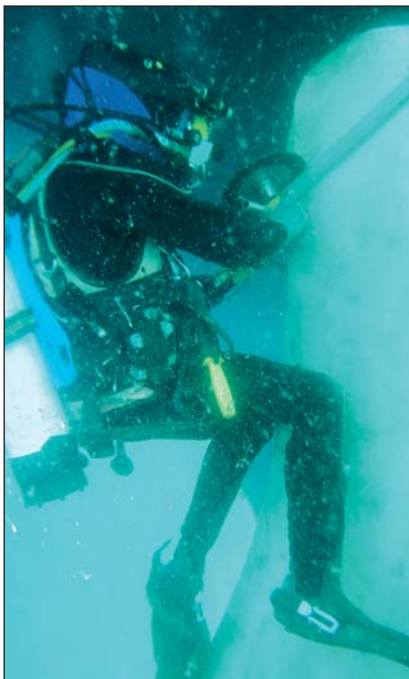
Hydrex diver cropping a propeller blade.
